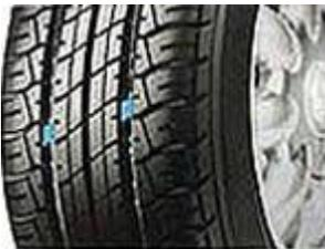
La parte plana del neumático que está en contacto con la superficie se denomina banda de rodadura. Es la zona que sufre más desgaste, por lo que es conveniente comprobar que la profundidad de las ranuras de su dibujo no es inferior a los 1,6 milímetros. En este caso deberemos sustituir el neumático.
